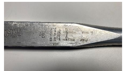
KRAFTRICHTUNG DES DREMOMETERS BEIM KONTERN BEACHTEN - PFEIL
