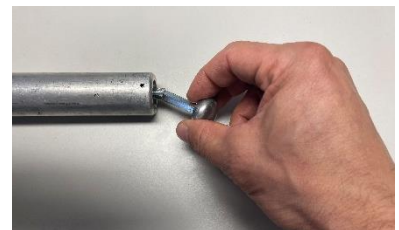
EINSTELLUNG DREHMOMENT DURCH HERAUSZIEHBARE KURBEL
